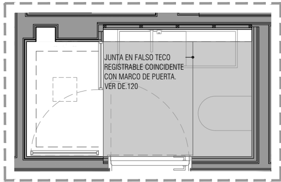
DESPIECE DE TECHO REGISTRABLE. BAÑO SECUNDARIO 02
